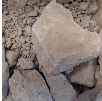
Basaltschotter (Körnung 0 - 32 mm, 10 cm Schütthöhe)
