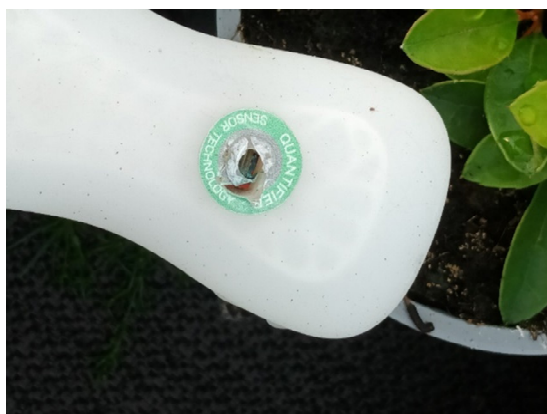
Abbildung 15: Schaden durch Vogelpicken an der Membran
