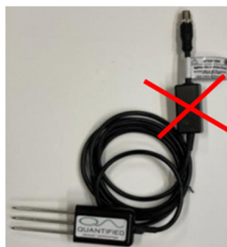
Abbildung 3: Auf die Zwischenbox kann mit dem Neptune verzichtet werden
